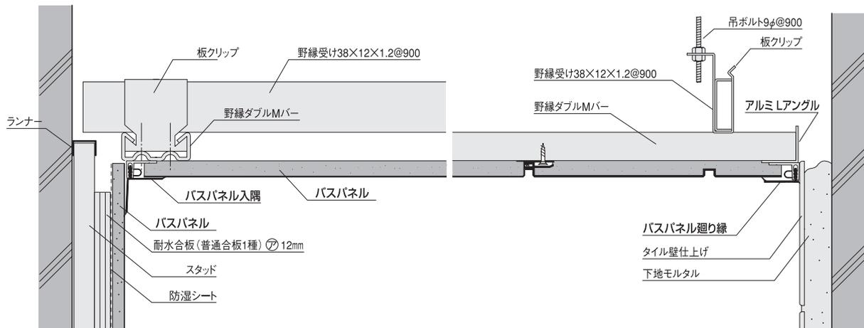
**⚠注意** ●バスパネルを取付ける際のビスは、**ステンレス 軽天ビス** (フレキタイプは不可)を使用してください。
