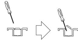
壁使用の点検時、マイナスドライバーを差し込み、カバーを開けて下さい。
