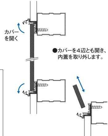
★塩ビ点検口枠の規格寸法は、内寸法です。
