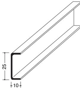
**53-42** C25チャンネル(振れ止め用チャンネル)
