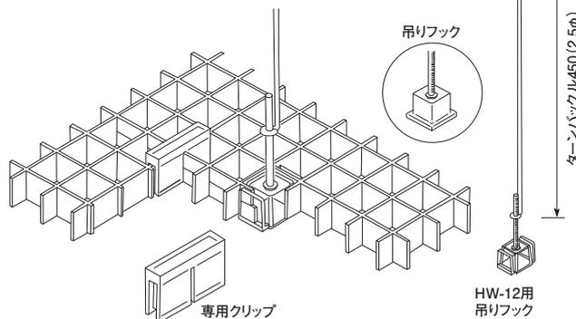
自重の垂れ(幅700以上の使用)の矯正には、専用のターンバックル、またパネルラインの目違いには専用クリップをご使用ください。
