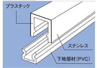
**かん合タイプ** 3000mm 先に下地部材を取付、その上に表面部材をはめ込んでください。かん合材の接着には接着剤を併用してください。
