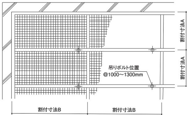
**ランナー工法** ランナー組みの交点でクロスジョイントと直ジョイントが重ならないように割付して下さい。
