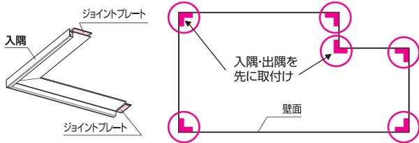
**注意** ●本体を取付ける際は、ジョイント部は隙間を空けず突き付けて施工します。
