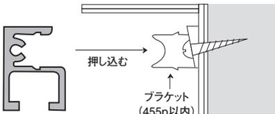
ブラケットを壁面に取り付けレールを押し込む
