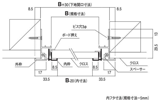
内フタ寸法(規格寸法-5mm)
