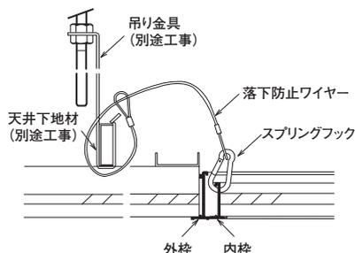
スプリングフックを内枠にある(回転軸側の)長穴に取付けて下さい。
